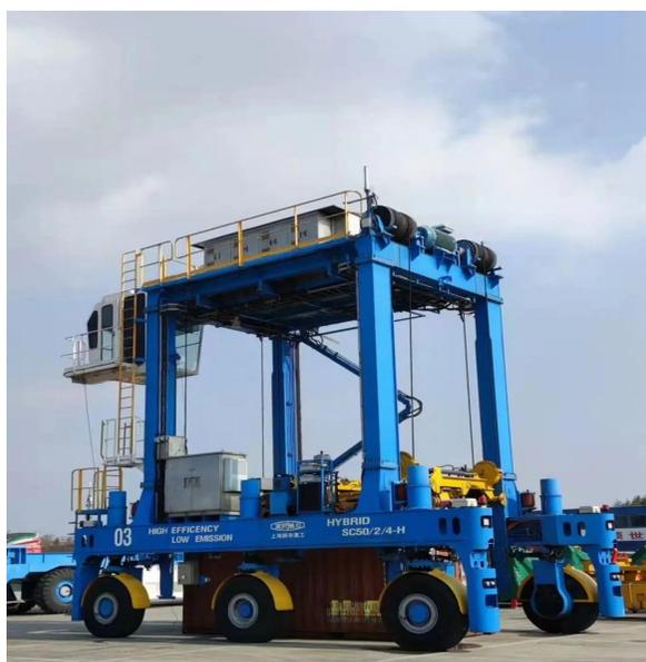
该款氢燃料跨运车是通过氢气和空气中的氧气将化学能转化成电能进行驱动，整个循环只产生水和热，不产生任何有害物质，真正实现“零碳排放”，填补了全球跨运车在“零碳”领域的空白。同时氢燃料电池运行非常安静，大约55分贝的噪声，相当于人们正常交谈的水平，大大降低了整个港口的环境噪音。
